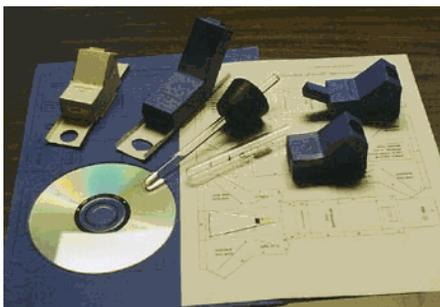
Fig. 13 – Construção de um espectroscópio.
