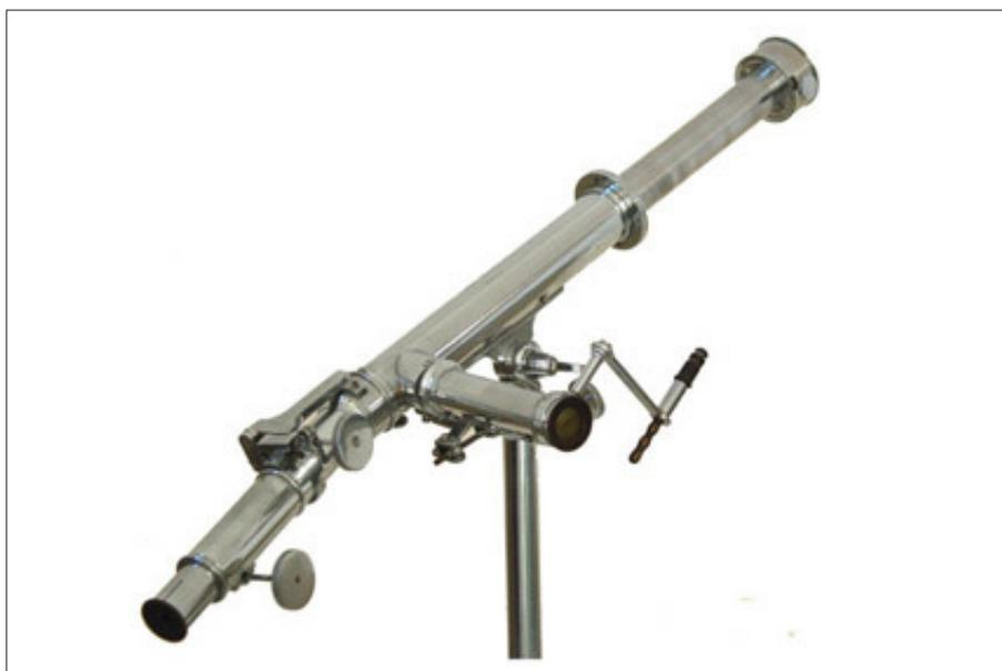
Fig. 8 – Espectroscópio de Bunsen-Kirchhoff, 1885.
